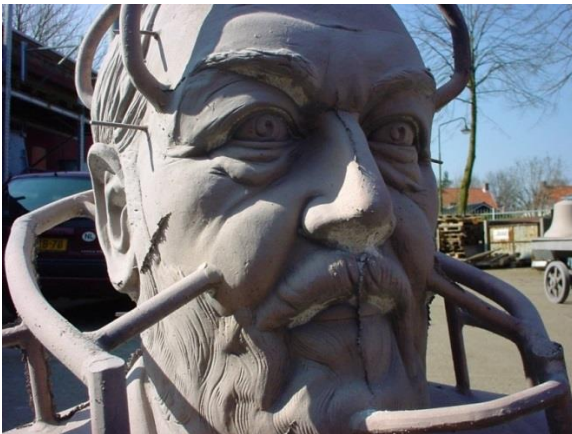
© Ákos Sziráki, Bronzeguss nach dem Sandstrahlen mit Entlüftungskanälen
